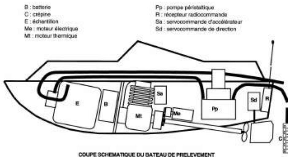
**Figure 2 : embarcation radiocommandée**
